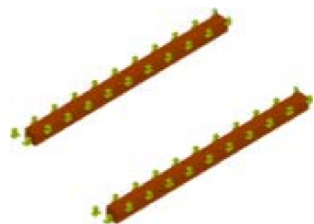
PHASE 1 Montaż klisów na legarach
